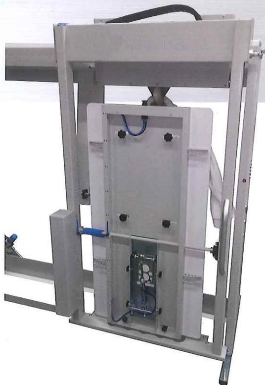
Con l'accappatoio in posizione orizzontale, il dipendente può piegare le maniche manualmente. Pieghie ripiegabili e pieghie trasversali vengono quindi realizzate mediante piastre pieghevoli. Le piegature longitudinali e pieghie pieghevoli pieghievoli sono regolabili in modo tale da poter piegare sia gli accappatoi piccoli che quelli grandi.
